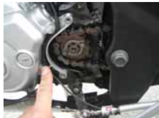
シフタースイッチ配線処理
