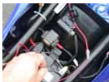
電源例① * テールランプより
